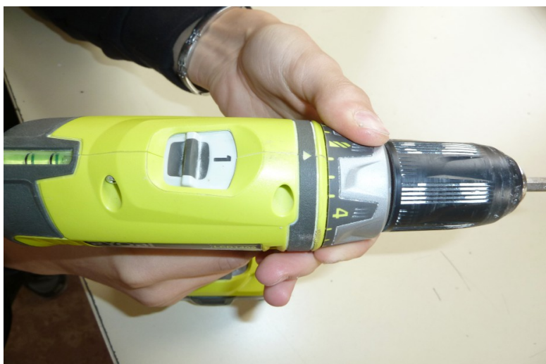
Figure 4 : main de l'utilisateur sur le sélecteur de couple (bague graduée) située au niveau du mandrin de la perceuse-visseuse-dévisseuse sans fils
